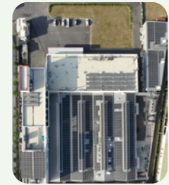
嘉義廠太陽光電與太陽能熱水系統空拍圖面 498KW 太陽能光電與 25 噸太陽能熱水系統
